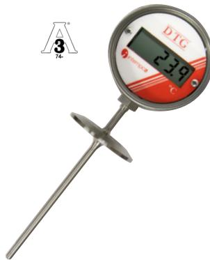
La jauge DTG91 alimentée par batterie est configurable par le client pour diverses applications sanitaires. Elle est disponible en montage supérieur, arrière, inférieur et latéral. Une sortie RTD à 3 fils est disponible pour la surveillance à distance. Des raccords sanitaires de différents types et tailles sont disponibles. De nombreux diamètres et types de sondes sont proposés. Trois finitions de surface sont proposées, y compris l'électro-polissage (EP) de haute qualité.
